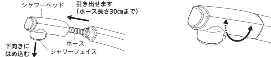
【△注意】シャワーヘッドを引き出しすぎないでください。ホースが戻しにくくなったり、ホース損傷により漏水で家財などを濡らす財産損害発生のおそれがあります。
