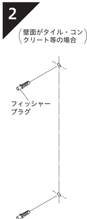
印の位置に同梱のフィッシャープラグを打ち込みます。(ドリル径φ6mm)
