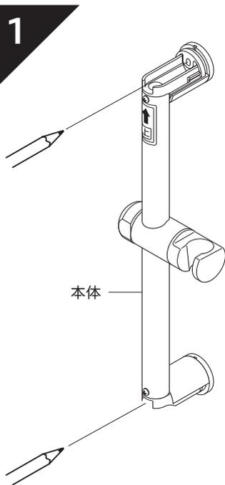
ハンガーキャップを外し、本体を壁面にて、取付け位置に印をつけておきます。
