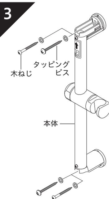
印の位置にビスをねじ込み、本体を壁に固定します。
