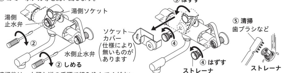
清掃後は、上記と逆の手順で組み込んでください。シャワー仕様の場合、ストレーナを締め込む時、吐水切換ハンドルを吐水口側にしてください。混合栓仕様の場合、ストレーナを締め込む時、吐水ハンドルを吐水側にしてください。
