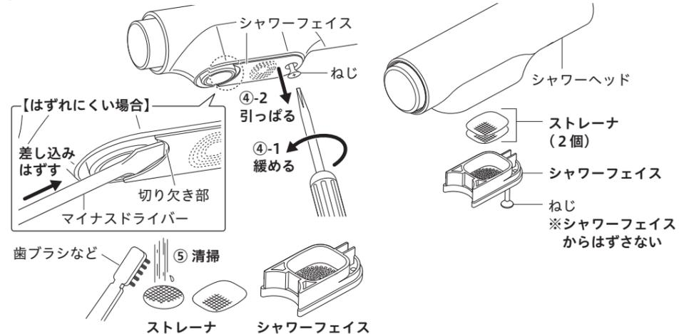
清掃後は、はずした逆の手順で組み立ててください。 【お願い】吐水金具・ねじを締め付け過ぎに注意してください。締め付け過ぎると部品の破損または水漏れ等をするおそれがあります。ストレート吐水が乱れる場合は、ストレーナにゴミの付着やストレーナが反ったりずれている場合がありますので再度組み付け直してください。
