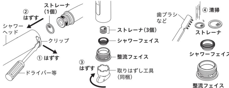
【清掃後の組み立て】 清掃後は、はずした逆の手順で組み立ててください。
