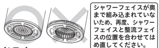
【お願い】止まるまで締め込んだら、それ以上締め込まないでください。破損するおそれがあります。締め付け不足の場合、漏水や切換不良の原因になります。
