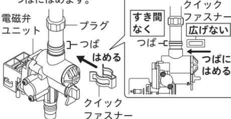
【△注意】電磁弁ユニットを下へ引っ掛けて、抜けないことを確認してください。しっかりはまっていないと漏水して家財などを濡らす財産損害発生のおそれがあります。
