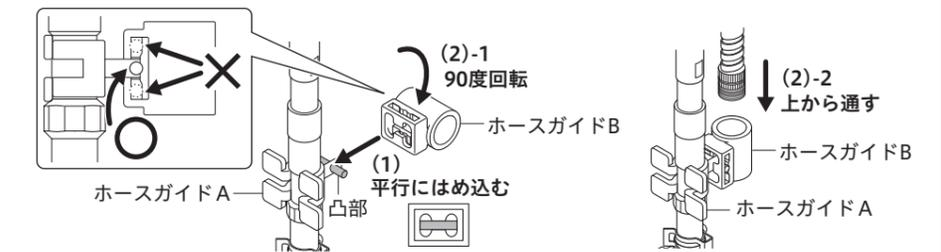
【△注意】固定した際、シャワーホースがA図のようにまっすぐ垂れ下がるようにしてください。B図のように、ブレードホースに引っ掛けたり、ひねったりしないでください。シャワーホースが破損し漏水により家財などを濡らす財産損害発生のおそれがあります。
