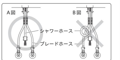
② チーズとカプラーの接続が緩んでいないか確認してください。(確認用の赤色マーキング有り) 緩んでいる場合はカプラー手締め後、約30度増し締めしてください。(締め付けトルクの目安は約100N・cm) カプラーユニットとシャワーホースを接続します。カプラーユニット手締め後、約30度増し締めしてください。(締め付けトルクの目安は約100N・cm)
