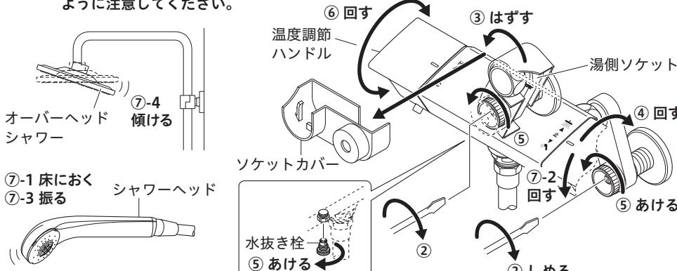
【お願い】上記と逆の手順で操作して通水を再開してください。必ず水抜き栓とストレーナがしまっていることを確認して、吐水切換ハンドルを「止」の位置にしてから通水してください。
