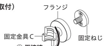
② 下図の寸法が37±1になるように固定金具Cをねじ込み調整します。
