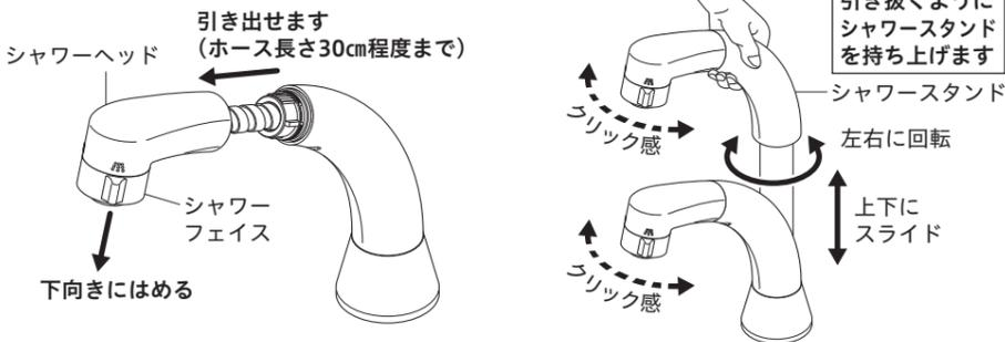
【△注意】シャワーヘッドを引き出しすぎないでください。ホースが戻しにくくなったり、ホース損傷により漏水で家財などを濡らす財産損害発生のおそれがあります。
