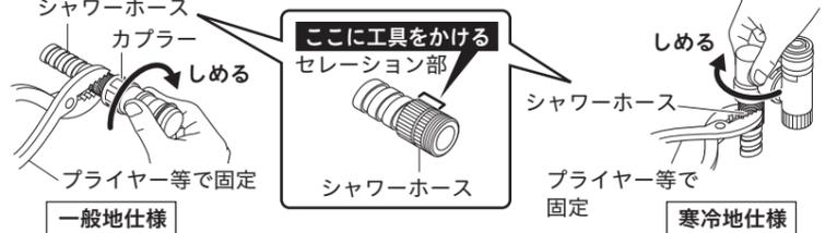
② カプラーのキャップをはずし、スライダーを下に下ろしてからプラグへカチッと音がするまではめ込みます。(寒冷地仕様の場合はエルボが下向きになっていることを確認します。)取り付け後、カプラー(寒冷地仕様は水抜き付きカプラー)を引っ張ってはずれないことを確認します。
