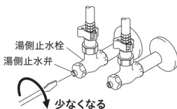
吐水温度がぬるい場合は、水側止水栓(止水弁)を絞る
