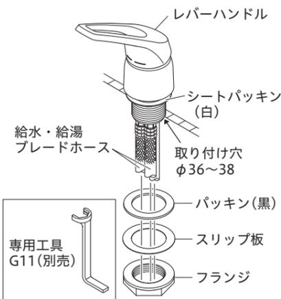
**4-1 止水栓との接続 (逆止弁付仕様、逆止弁無し仕様共、接続方法は同じです。)**
