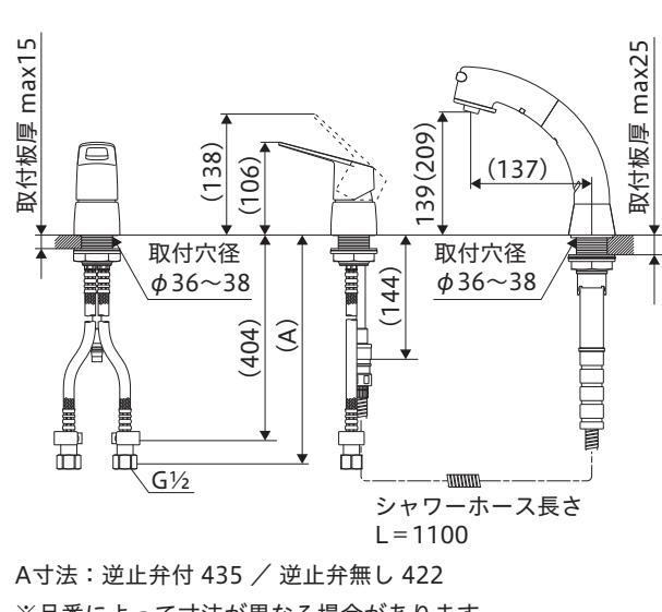
A寸法: 逆止弁付 435 / 逆止弁無し 422
