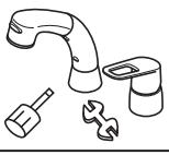
配管などの解氷のため、解氷機を使用する場合は、水栓(給水・給湯管含む)には絶対に通電しないでください。
