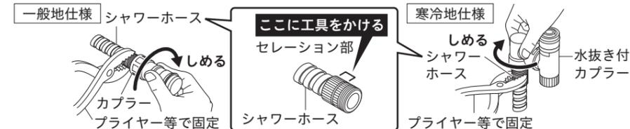
② カプラーのキャップをはずし、スライダを下に下ろしてから、プラグヘカチッと音がするまではめ込みます。(寒冷地仕様の場合はエルボが下向きになっていることを確認します。)取り付け後、カプラー(寒冷地仕様は水抜き付カプラー)を引っ張ってははずれないことを確認します。
