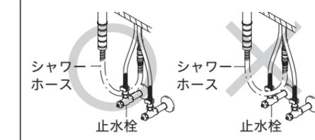
**注意** カプラー取り付け後、確実に接続されているか、下記の確認を行ってください。確実に接続されていないと、漏水して家財などを濡らすおそれがあります。・スライダーが上がっていること
