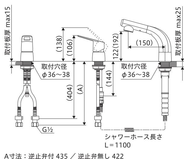
A寸法: 逆止弁付 435 / 逆止弁無し 422
