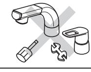
配管などの解氷のため、解氷機を使用する場合は、水栓(給水・給湯管含む)には絶対に通電しないでください。
