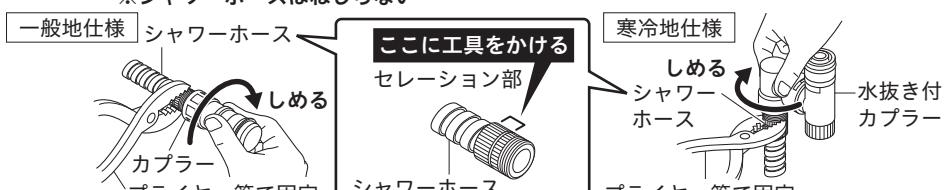
② カプラーのキャップをはずし、スライダーを下に下ろしてから、プラグヘカチッ音がするまではめ込みます。(寒冷地仕様の場合はエルボが下向きになっていることを確認します。)
