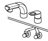
小型電気温水器(即湯器)等に給湯ホースを接続する際は、ステンレスフレキ管等を介してください。
