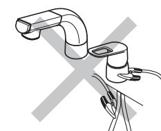
通電すると水栓や給水・給湯管が発熱し、破損して漏水で家財などを濡らす財産損害発生のおそれがあります。
