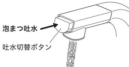
【お願い】 流量が多いと切替わりにくい場合がありますので、その際は流量を調節してお使いください。(取扱説明書10ページ「止水栓による流量の調節方法」参照)
