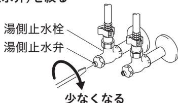
吐水温度が低い場合は、水側止水栓（止水弁）を絞る
