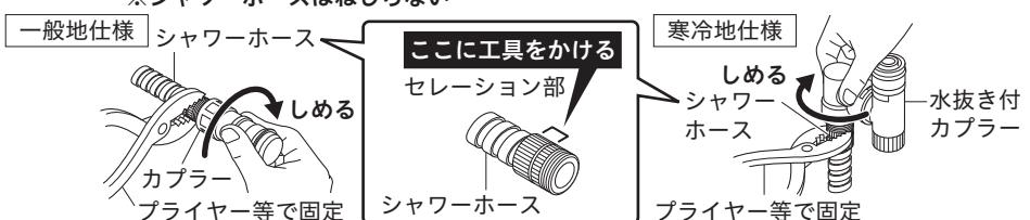
② カプラーのキャップをはずし、スライダーを下に下ろしてから、プラグへカチッ音がするまではめ込みます。(寒冷地仕様の場合はエルボが下向きになっていることを確認します。)
