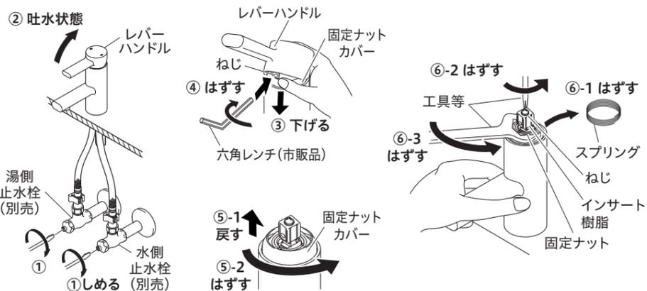
水栓本体内部のメンテナンス後は、はずした逆の手順で組み立ててください。その際、レバーハンドルにねじを仮締め後、レバーハンドルを組み付け、ねじをねじ込んでください。
