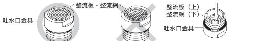
② 吐水口金具に泡まつ器を入れ、パッキンをはさみ、シャワーヘッドにシャワーフェイスをはめてからシャワーヘッドに手締め後、工具で約1/3回転(約120度)増し締めしてください。(締め付けトルクの目安は約75N・cm)
