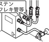
**必ず実行** 凍結が予想される際は、一般地仕様をお使いの場合は少量の水を出しておくか配管に布を巻くなどして凍結を防止してください。
