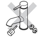
**禁止** 配管などの解氷のため、解氷機を使用する場合は、水栓(給水・給湯管含む)には絶対に通電しないでください。
