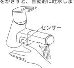
〔止水する〕 センサーに手をかざすと、自動的に止水します。
