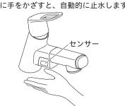
⑤ センサーまたはレバーハンドルを閉じて止水し、接続部からの水漏れがないことを確認してください。
