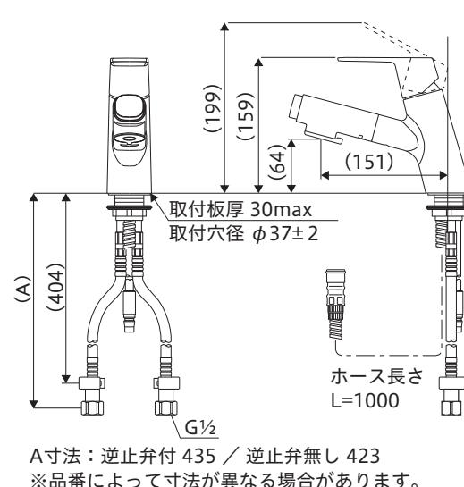
A寸法: 逆止弁付 435 / 逆止弁無し 423
