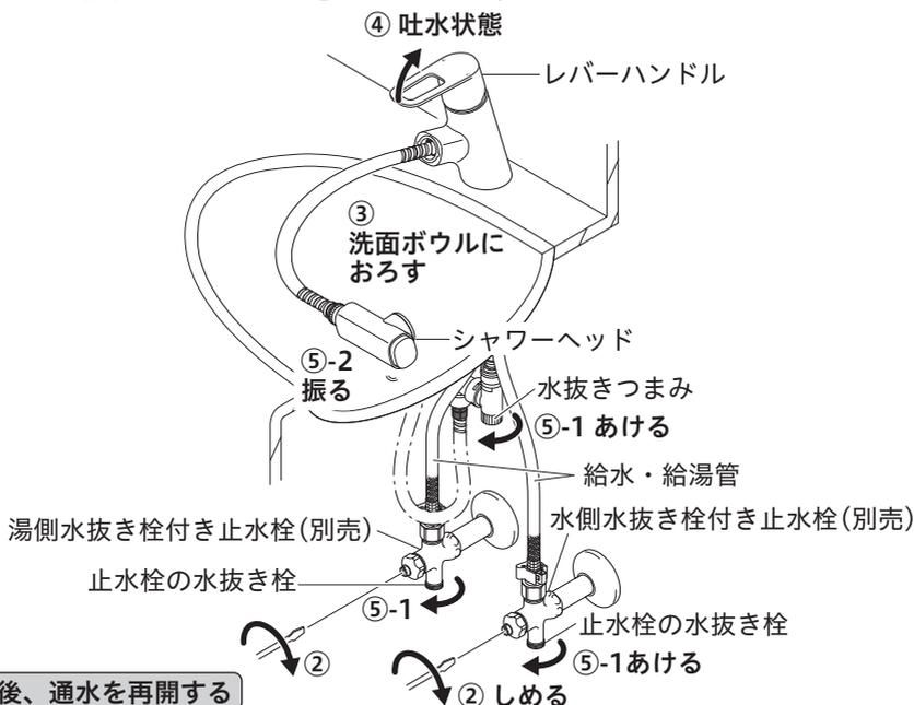
水抜き後、通水を再開する
