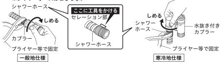
② カプラーのキャップをはずし、スライダーを下に下ろしてからプラグへカチッと音がするまでは め込みます。(寒冷地仕様の場合はエルボが下向きになっていることを確認します。) 取り付け後、カプラー(寒冷地仕様は水抜き付きカプラー)を引っぱってはずれないことを確認します。
